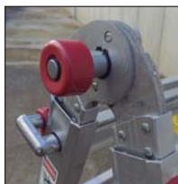
Detalle bisagra automática
